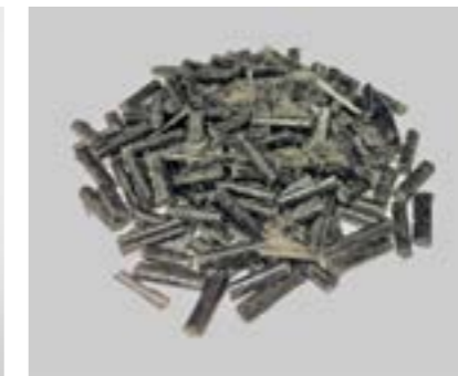
Gute Glasfaseranbindung nach Coffeemill-Test
